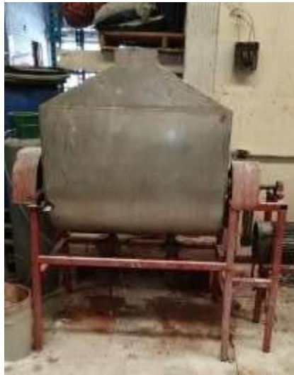
Figura 6.2 Máquinas revolvedoras de pulpa para el dulce de tamarindo Fuente: Kepulpa mayoreo dulcero S.A. de C.V. 2021
