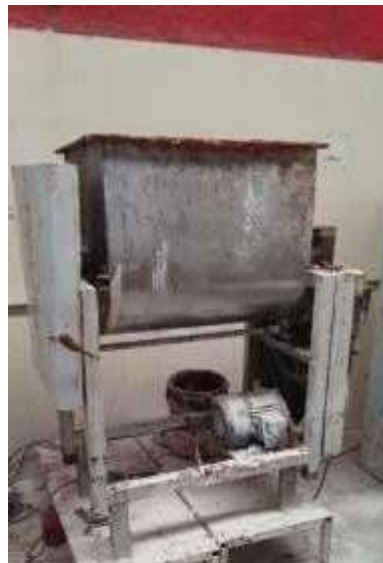
Figura 6.3 Máquinas revolvedoras de pulpa para el dulce de tamarindo Fuente: Kepulpa mayoreo dulcero S.A. de C.V. 2021
